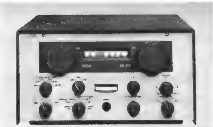
Racal RA 217, ein neuer Transistor-Kurzwellenempfänger für die Bereiche 1...30 MHz mit digitaler Frequenzanzeige und der Schaltung des bekannten mit Röhren bestückten Modells RA 17
